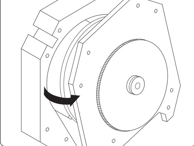
**6** 拉出刀盤時，須注意下冰擋板(白色尼龍板)左右各1片，從二側取下。
