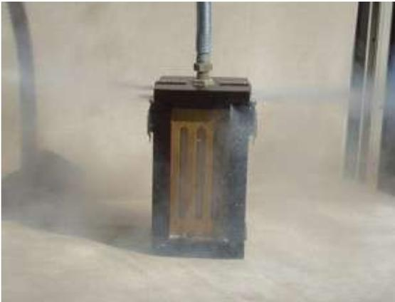
⑦ボックス内にドライアイスが形成されると、蓋とケースとの間からガスが噴出しますので直ちにバルブを閉める——完成。
