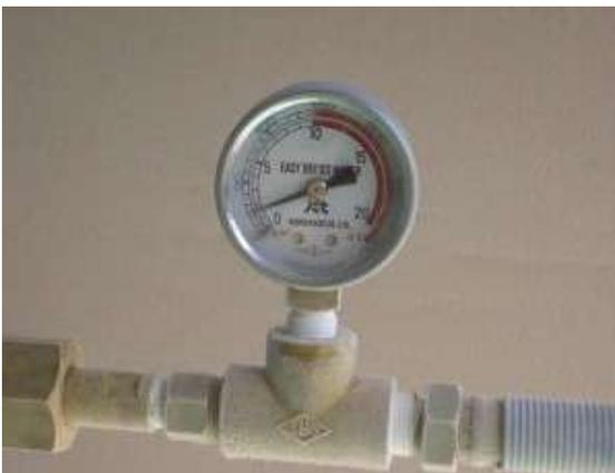
⑥ ドライアイス製造中の圧力計の指針を「0.2~0.4MPa」にポンペのバルブで調整する。
